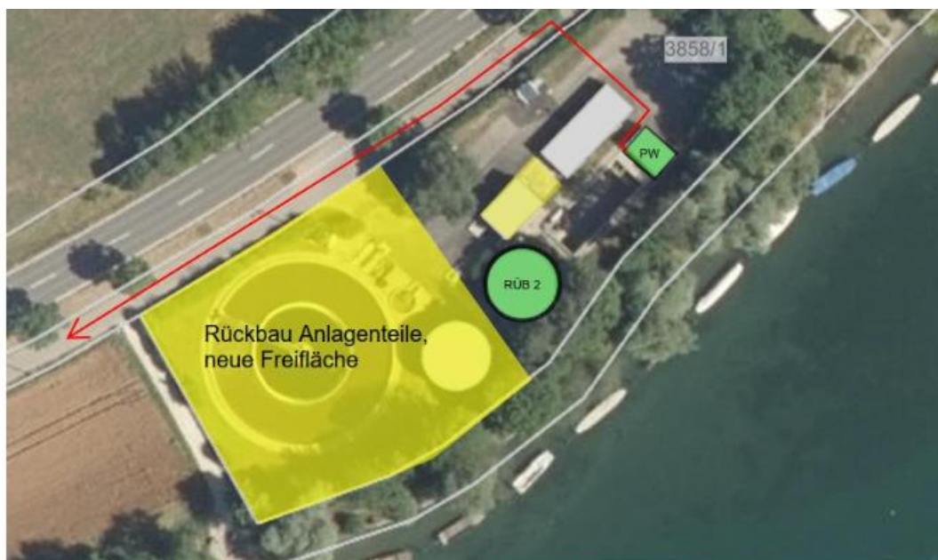
Abbildung 4: mögliches Anlagenlayout bei Aufhebung der KA Büsingen und Umbau zu Pumpwerk (gelb: Rückbau, grün: Umnutzung bestehender Bauwerke) (Luftbild mit Geobasisdaten: Daten- und Kartendienst der LUBW)
